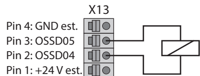
Figura 7.13 Cablaggio del controllo di frenatura - Esempio 2
